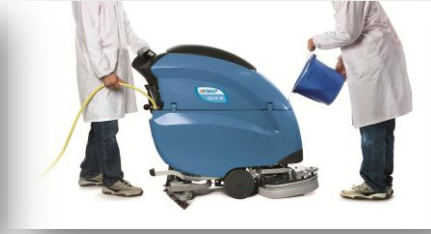
Täyttö sangolla edestä tai letkulla ja Mx ja SMx malleissa letkulla takaa
